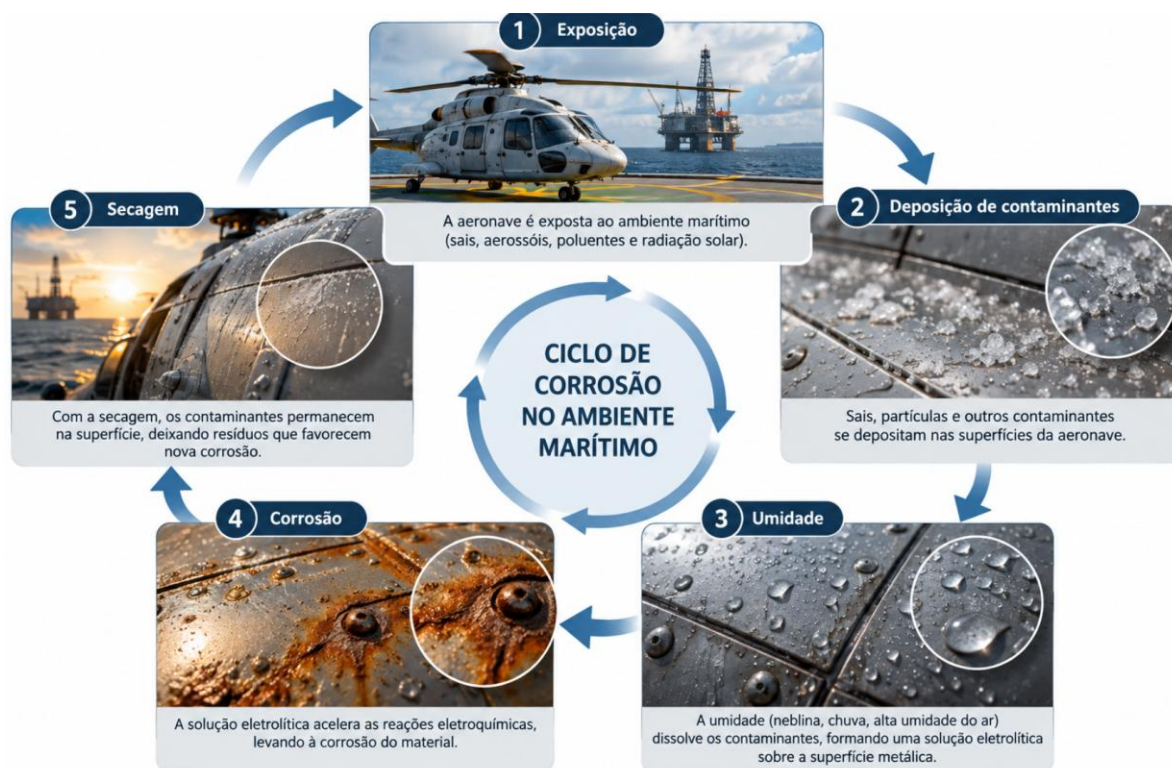
Figura 1 – As cinco etapas que contribuem para o ciclo de corrosão
