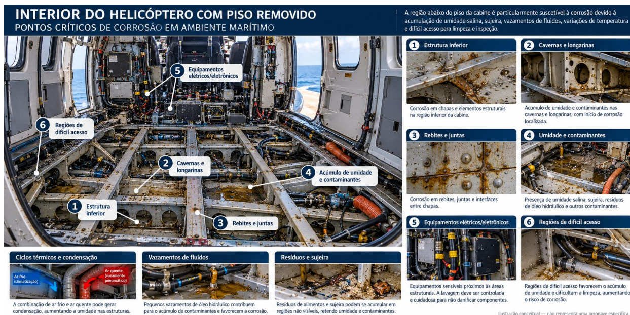
Figura 6 – Região interna sob o piso de helicóptero: pontos críticos de corrosão em ambiente marítimo
