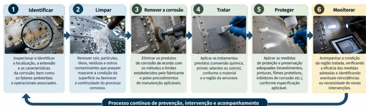
Figura 5 – Sequência de controle da corrosão em estruturas aeronáuticas
