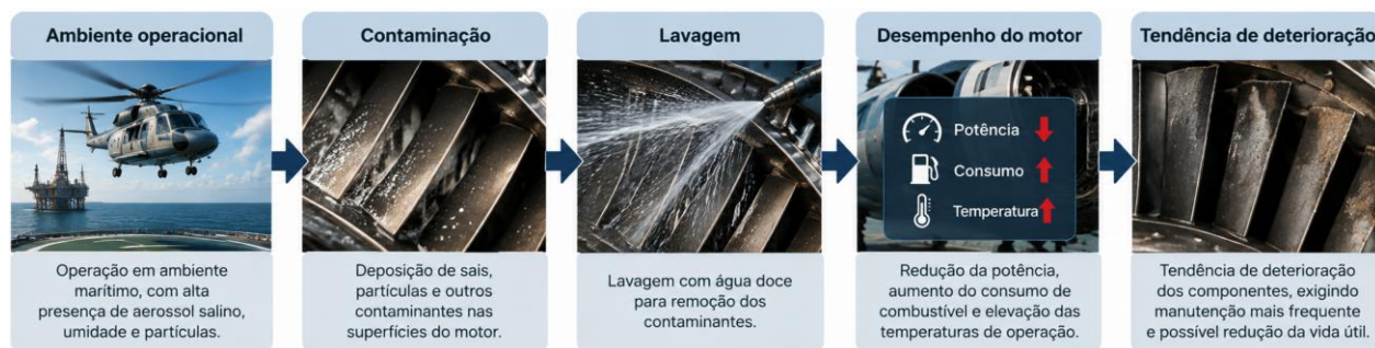
Figura 4 – Relação entre operação, contaminação, lavagem, desempenho e deterioração do motor
